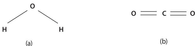
Figura 15. (a) Las líneas de los enlaces oxígeno-hidrógeno tienen una dirección determinada en la molécula de agua y ambos enlaces apuntan a  $104^\circ$  uno del otro. (b) En el dióxido de carbono los dos enlaces tienen la misma direccionalidad y se encuentran a  $180^\circ$  uno del otro.
